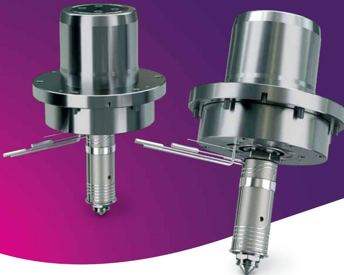
**La conformazione compatta del sistema di iniezione a otturatore con ugello singolo VeriShot™ riduce notevolmente i requisiti di altezza dello stampo, conferendogli anche una funzione di anello di posizionamento, per assicurare il perfetto allineamento tra stampo e piastra della macchina.**
